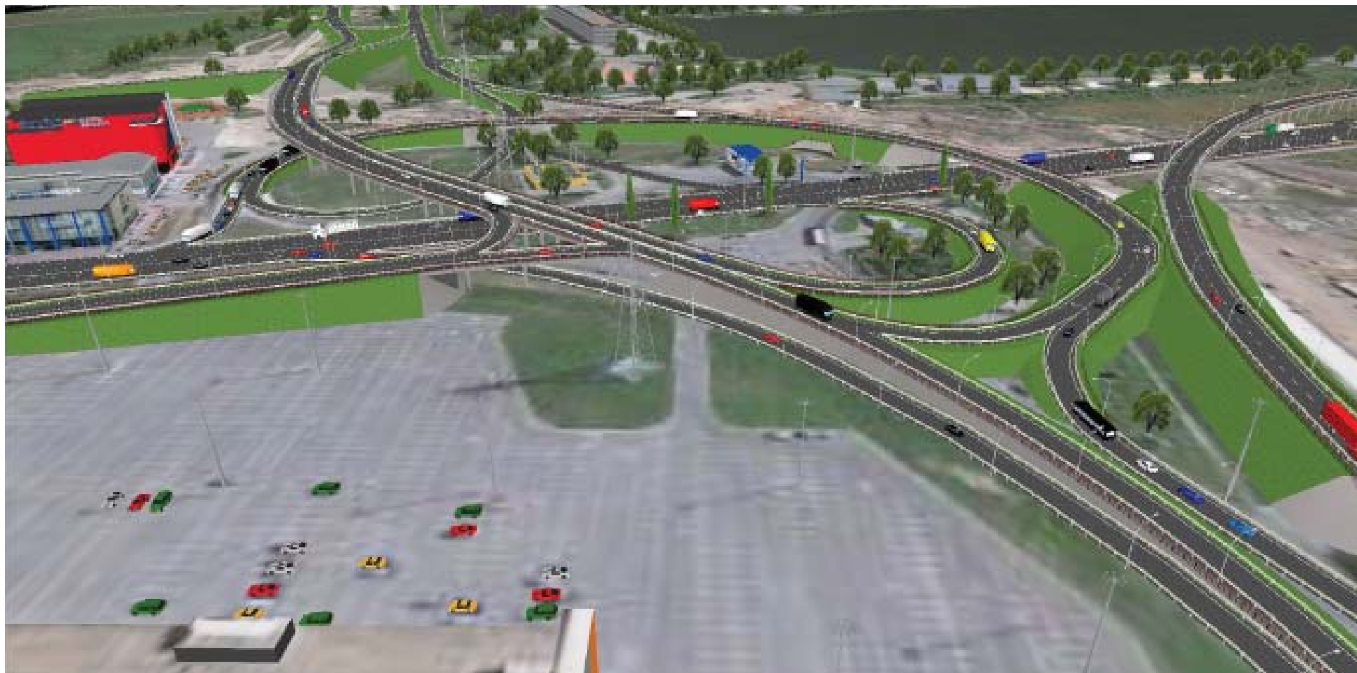
Оценка пропускной способности проектируемого участка автомагистрали М-4 «Дон» (южный подъезд к г. Ростову-на-Дону). PTV Vision VISSIM
